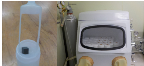
試料と浸漬容器 保管状況(グローブボックス内)
