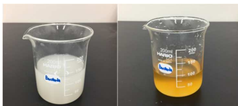
写真-1 微生物を用いた補修材 (左) イースト菌; (右) バチルス菌
