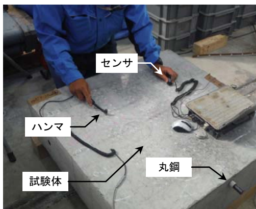
写真-1 多点表面伝搬時間差法の測定状況
