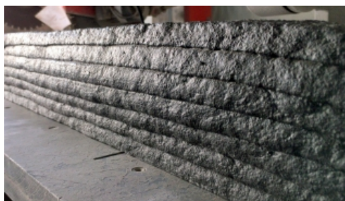
図-6 3D プリンティングで作製した壁試験体
