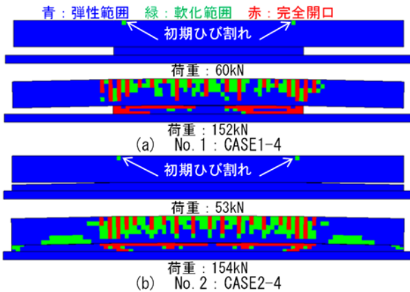
図-14 スラブ軌道模型供試体のひび割れ状況
