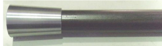
写真-1 テーパ型ナットを PC 鋼棒にセットした状況
