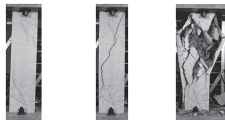
(a) 最大耐力時 (b) せん断破壊後 (c) 崩壊時
