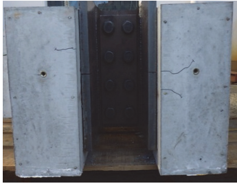
写真-4 疲労試験におけるコンクリートの破壊状況
