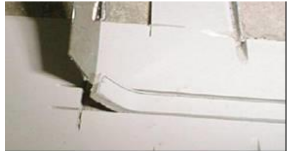
写真-1 カッターナイフ剥離試験 6)
