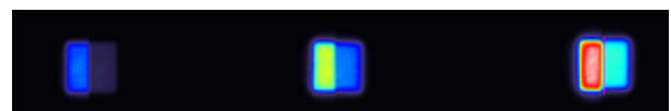
図-8 セメントペースト薄片（17mm 角）の IP 像（各右半分のみ 0.5mm 厚さのプラスチック板で遮蔽） 左：Cs-137-1MBq/kg、中央：Sr-90-0.33MBq/kg、 右：Cs-137-1MBq/kg + Sr-90-0.33MBq/kg 混合
