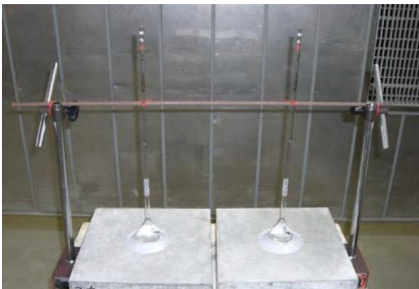
写真-1 透水量試験状況
