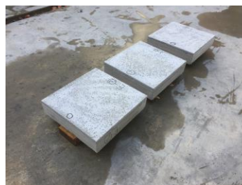
写真-1 発熱モルタルブロックの暴露状況
