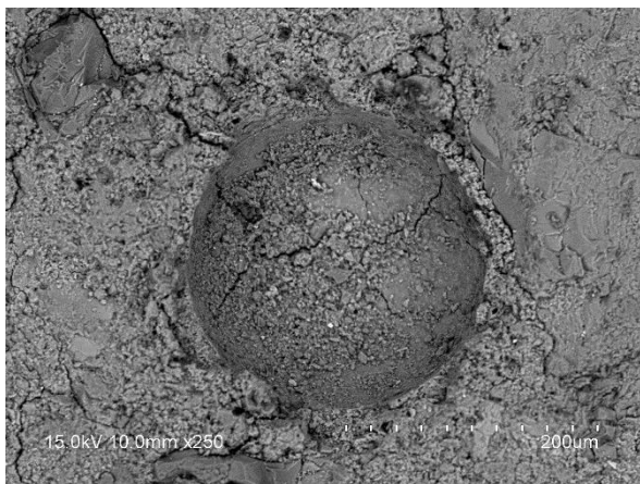
図-8 浸漬50日のコンクリート「2%-4.0%」のSEM観察写真
