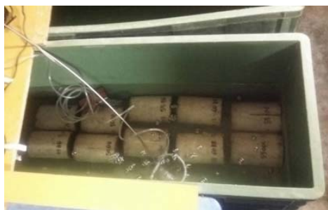
写真 - 1 塩分浸漬試験状況
