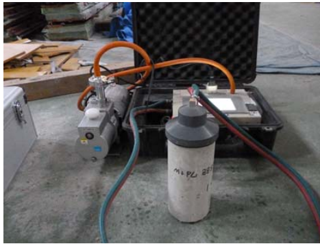
写真 - 2 供試体の表層透気試験状況
