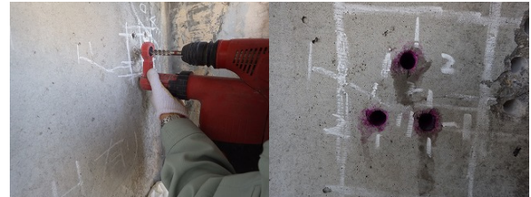
(a)ドリル試料採取 (b)試料採取済み孔
