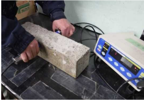
写真-4 超音波による相対動弾性係数の測定状況
