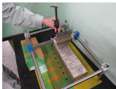
写真-3 スケーリング深さの測定状況
