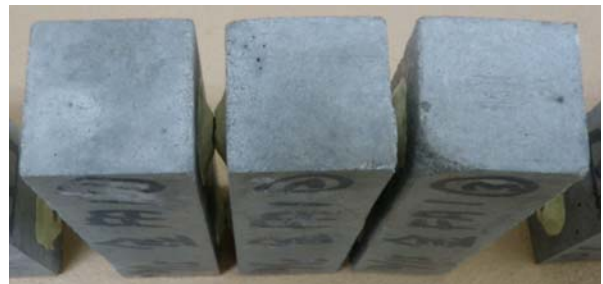
写真-3 促進膨張量試験後の状況 (反応性骨材・FA混和)
