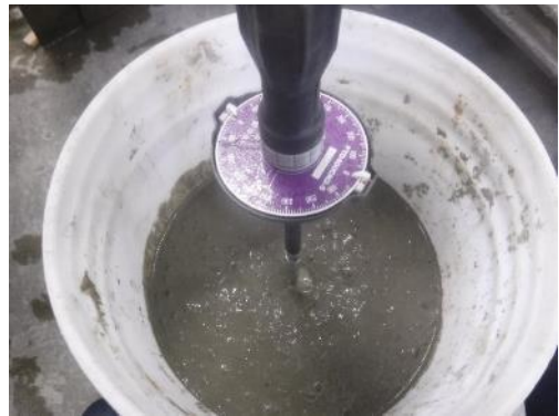
写真-1 ベーン試験実施状況
