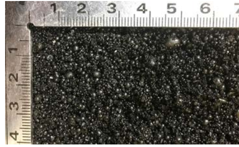
写真-1 電気炉酸化スラグ細骨材の外観形状
