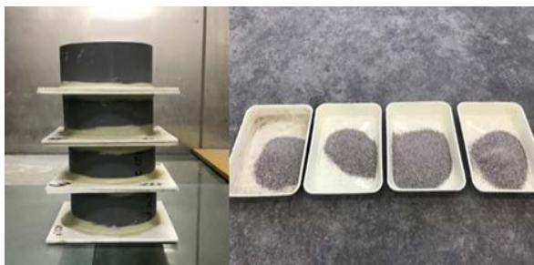
写真-2 (左) 4層円筒容器; (右) 絶乾状態の細骨材
