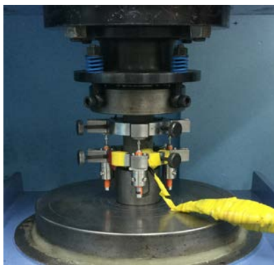
図-12 側面に変位計を4か所つけた歪測定装置
