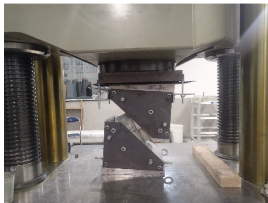
写真-7 簡易一面せん断試験状況
