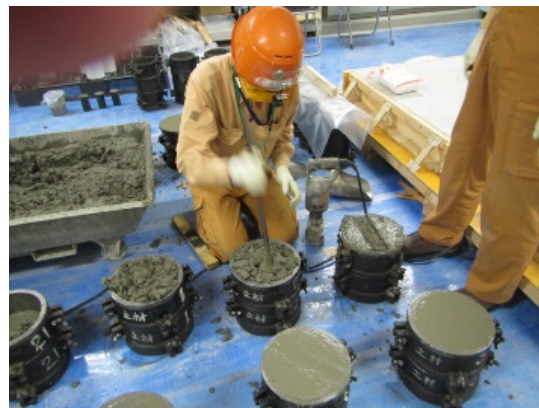
写真-6 一面せん断試験体製作状況
