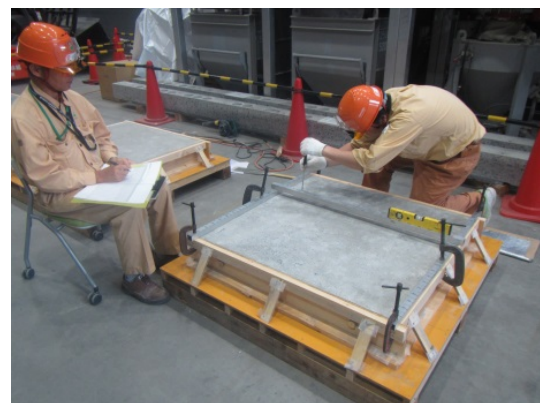
写真-5 粗骨材の露出計測状況
