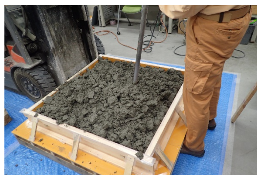
写真-1 コンクリート打込み状況
