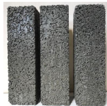
写真-2 試験体の底部の垂れの状況の例 (設計 V_R = 15%)
