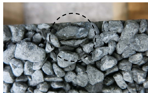
写真-3 骨材の割れの様子 (シリーズ I : 反応性骨材・設計空隙率 30%)
