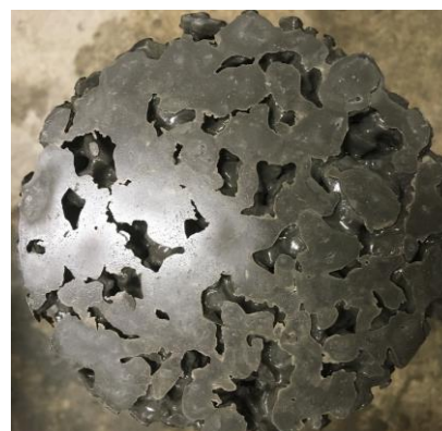
写真-2 試験体底面のペーストだれの状況 (HAE/C=0.4%, 経過時間0分)
