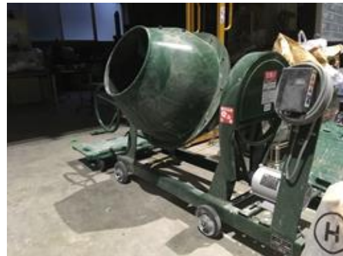
写真-1 練混ぜおよび低速攪拌時に用いた傾胴式ミキサ
