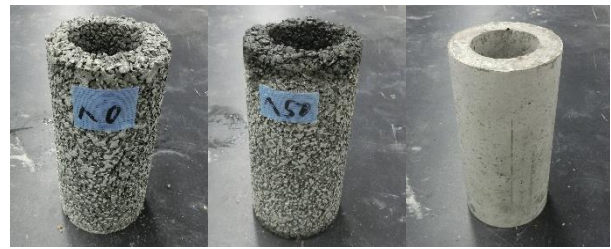
(a)普通ポーラス コンクリート (b)底泥ポーラス コンクリート (c) 底泥 モルタル
