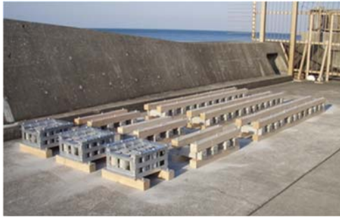
写真-1 飛沫帯曝露状況（曝露開始時）
