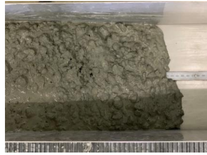
写真-1 OPC-FA-S の加振 L フロー試験後の様子
