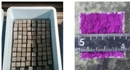
図-1 供試体の模擬酸性雨への浸せきの様子（左）と劣化サイクル実施後の劣化深さ（右）
