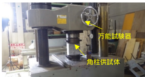
写真 - 1 万能試験機による角柱供試体への荷重載荷状況
