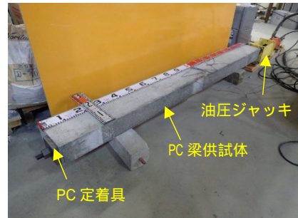
写真 - 2 油圧ジャッキによるプレストレス載荷状況
