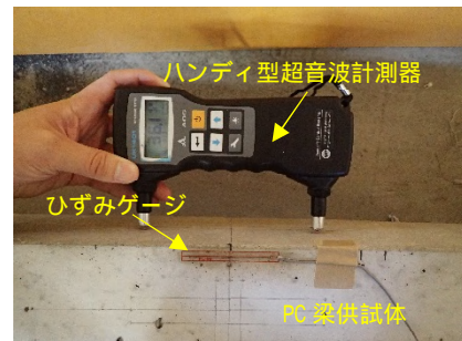
写真 - 3 ハンディタイプの超音波計測機
