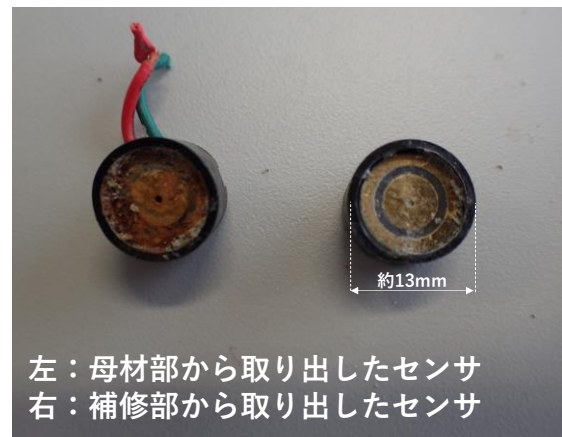
図-5 小型埋設センサの状況 (材齢 118 日目 No.2)
