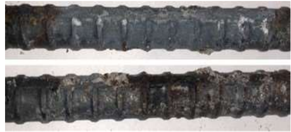
図-15 解体時の鉄筋の腐食状況 (湿布養生, w/c=55\% , \text{NaCl}=5\text{kg}/\text{m}^3 , 腐食有)
