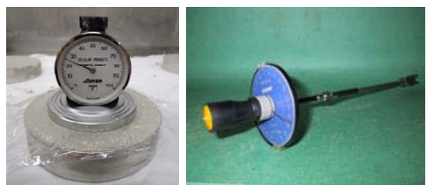
写真-1 ゴム硬度計およびベーンせん断試験機
