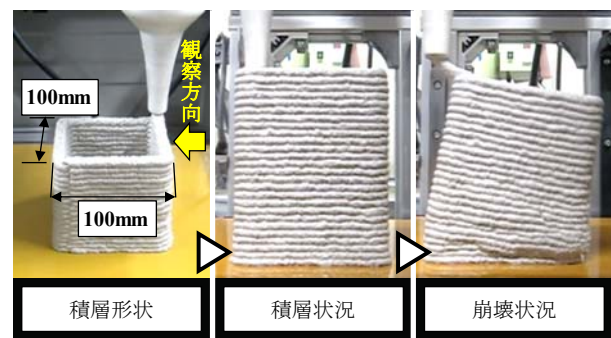
写真-2 積層体の積層・崩壊状況
