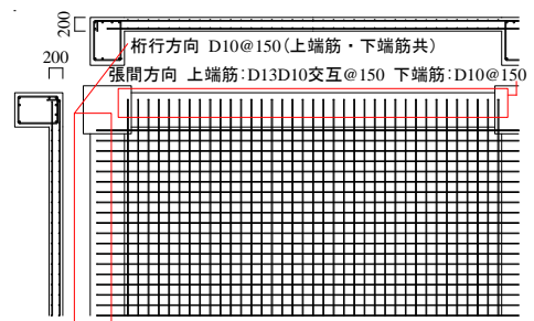
図-4 スラブ筋配筋図 単位: mm
