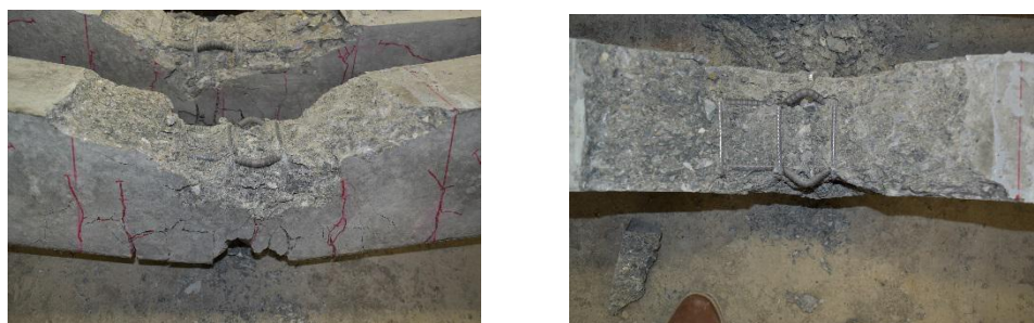
写真-2 圧縮鉄筋の座屈
