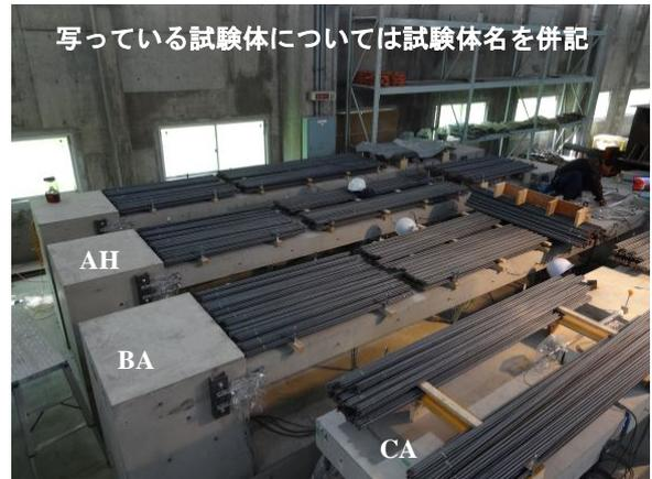
写真-1 試験体留置状況および載荷用鉄筋の積載状況
