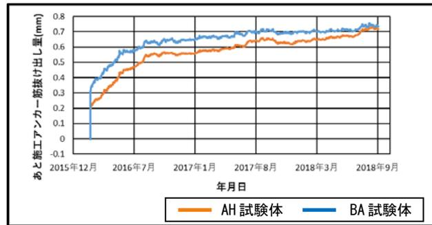
図-7 あと施工アンカー筋のスタブからの抜け出し量の経時変化
