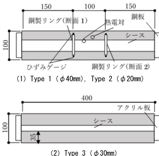
図-1 供試体概要 (図中単位 : mm)
