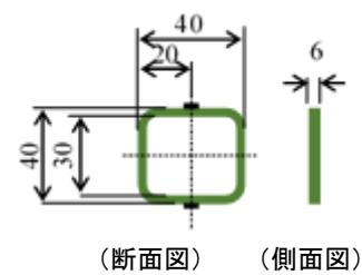
図-3 鋼製リング詳細図 (図中単位 : mm)
