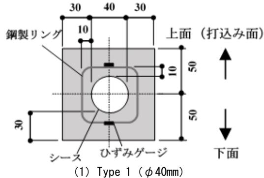
図-2 供試体断面図 (図中単位 : mm)
