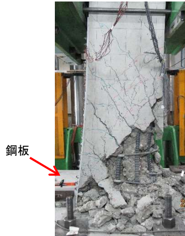
図-12 試験体 No. 3 載荷終了時の損傷状況
