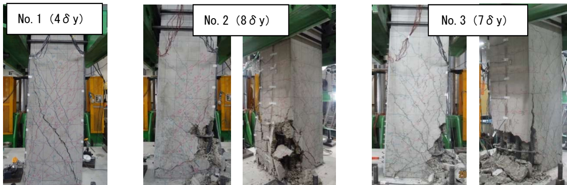
図-5 降伏荷重を下回らない最大変位時の損傷状況
