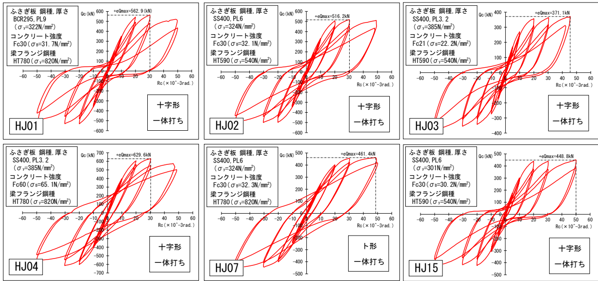
図-3 J型試験体の柱せん断力 Q_c -層間変形角 R_c の関係
