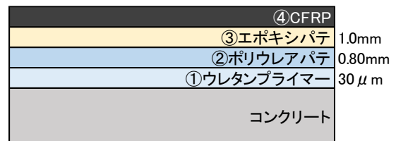
(b) 現場施工型従来工法 (ポリウレア有)
