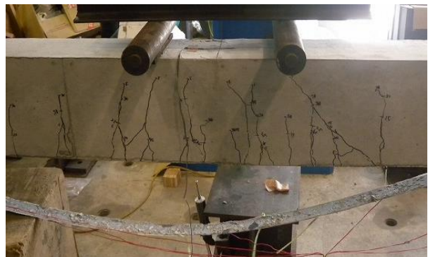
(a) CFRP プレートの剥離破壊 (1HTN(2200))
