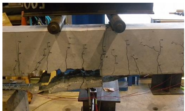
(b) コンクリートかぶり部の剥落破壊 (1HTS(1700))
