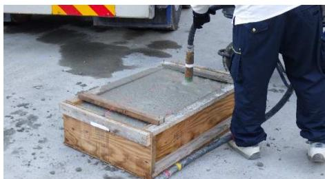
写真-2 締固め試験実施状況
