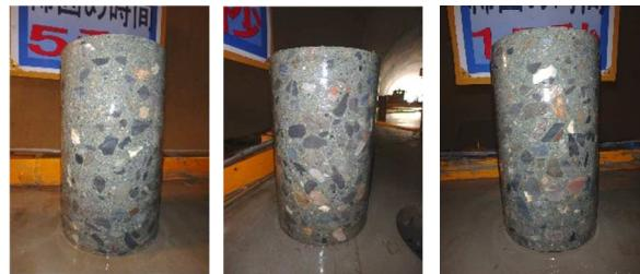
写真-6 気泡間隔係数測定用コア供試体
