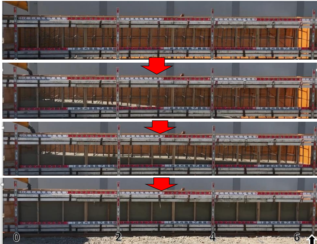
写真-4 壁状模擬型枠を用いた流動実験における低セメント量の高流動コンクリートの流動状況
