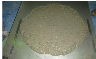
写真-3 スランプの状態(測定値スランプフロー60cm)
