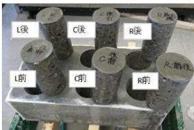
写真-4 加熱養生試験体のコア抜き箇所
