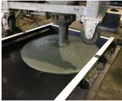
図-5 繊維補強 PFC の打込み
