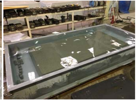
図-7 脱型後の煮沸吸水処理
