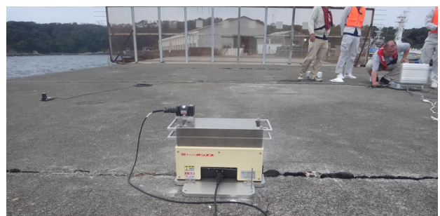
図-8 漁港施設防波堤の起振機設置状況
