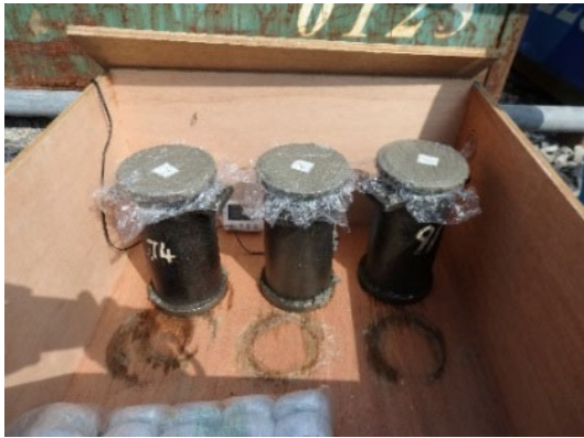
写真-2 現場保管養生箱
