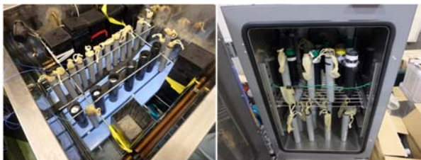
凍結融解試験機 (-18~5°C用) 恒温恒湿器 (-3~5°C用) 図-5 凍結融解試験状況
