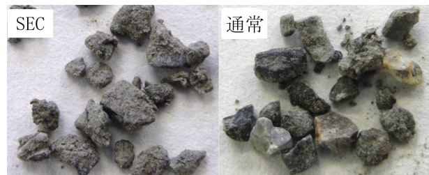
写真-1 SECおよび通常練混ぜコンクリートの細骨材
