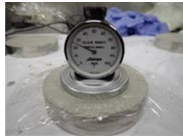
写真-1 ゴム硬度計 (デュロメータ F 型)
