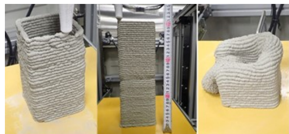
写真-2 積層試験実施状況 (左: S1=150%, 中央: S1=120%, 右: S1=90%)
