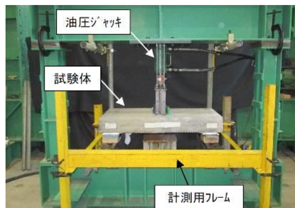
写真-6 荷重装置
