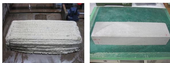
写真-3 曲げ試験体製作状況
